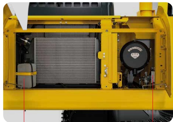
Estanque de reserva
