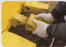
Coloque el diente PAB en el adaptador tipo pasador horizontal.
